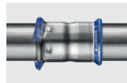
Färgade indikatorer identifierar opressade Mapress-rördelar även före tryckprovningen.
