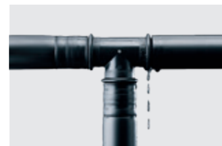
De definierade läckagevägarna gör att opressade rördelar syns direkt vid tryckprovningen.
