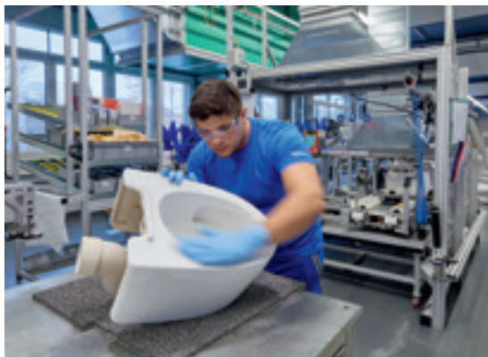
Montering av duschtoaletter..
